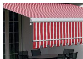
Die Das Volant-Plus (absenkbarer Volant; nicht bei allen Modellen verfügbar) wird mittels Handkurbel ausgefahren. Je nach Montageseite des Getriebes ändert die Auf-/Abrollrichtung. Falls sich das Fallprofil nicht vollständig zum Volantprofil einfahren lässt, muss der Volant-Plus nochmals ganz ausgefahren und in entgegengesetzter Richtung erneut eingefahren werden.
